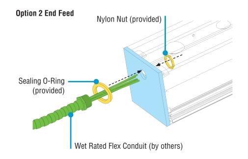
· Install wet rated conduit onto the luminaire.
